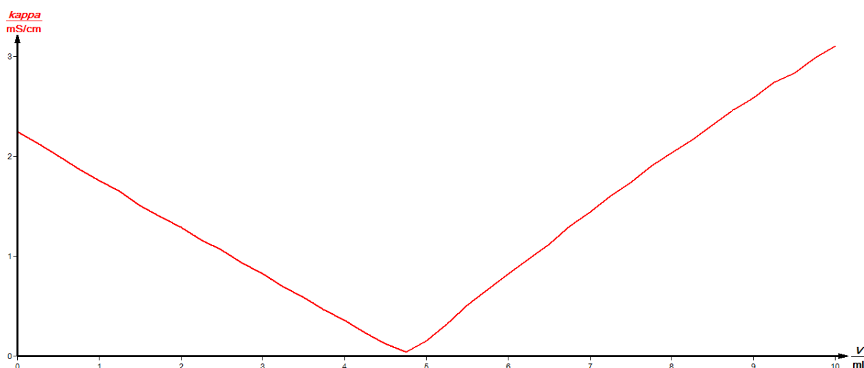
Рис. 3: Изменение удельной электрической проводимости K при титровании 0,1-молярного раствора гидроксида бария ( V = 5 мл) с серной кислотой ( C = 0,1 \text{ м} \cdot \text{л}^{-1} ).
