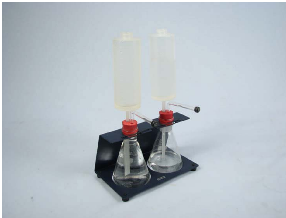
Рис. 3: Установка сосуда для хранения газа
