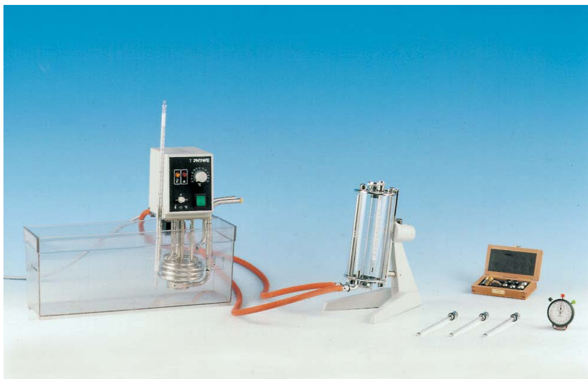
Рис. 1: Экспериментальная установка: Измерение вязкости при помощи вискозиметра с падающим шариком
